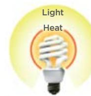
**في المصابيح الفلورسنت المدمجة (CFL)،** يمرّ التيار الكهربائي في أنبوب يحتوي على غازات. ينتج عن هذا التفاعل ضوء فوق بنفسجي يتحوّل إلى ضوء مرئي من خلال إضاءة الفلورسنت (التي تسمى بالفوسفور) من الجانب الداخلي للأنبوب.
